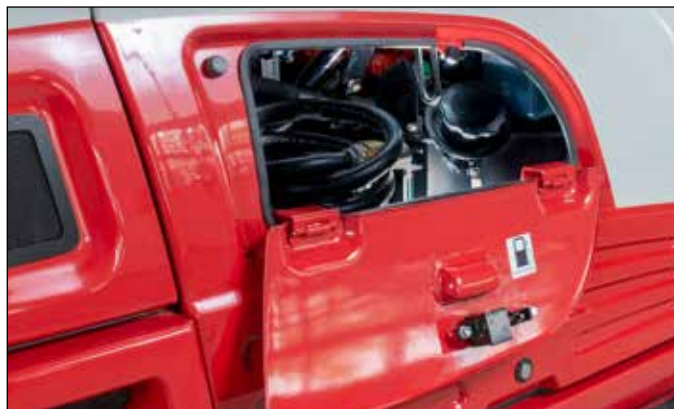
Tampa rebatível para um acesso à bomba de reabastecimento e ao depósito de gasóleo.
