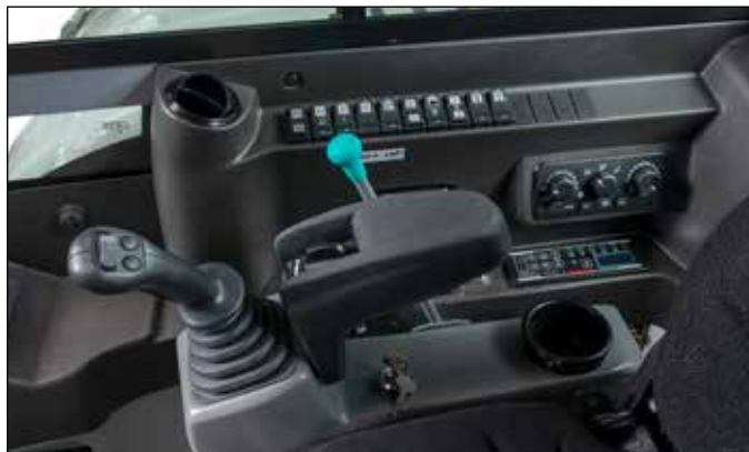
Direção proporcional da linha hidráulica auxiliar desde o joystick esquerdo e direito.
