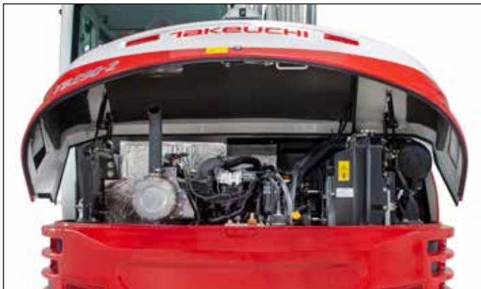
Motores com reduzidos níveis de consumo, ruídos, emissões de gases e filtro de partículas, com filtro de partículas auto-regenerante.
