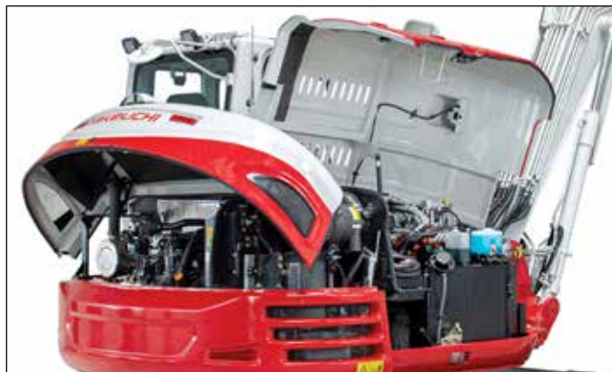
Amplio capô rebatível para facilitar o acesso cómodo a todos os componentes hidráulicos e do motor.
