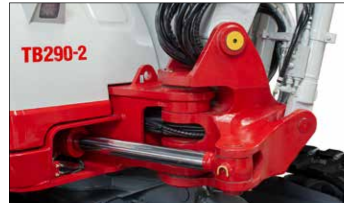
Robusto bloqueio de giro. Cilindro de elevação com amortecimento no final de curso, balancil e giro de braço. Aviso de sobrecarga e válvula anti-retorno.
