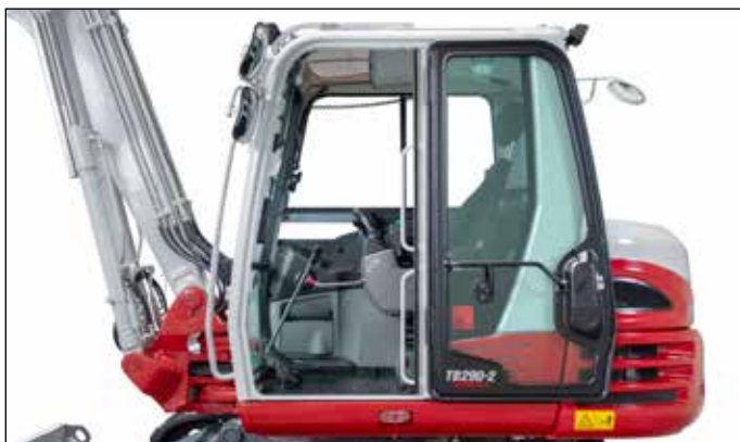
Ampla cabine insonorizada com poucas vibrações, compartimentos de armazenamento, entrada larga, fixação da porta, vidro frontal rebatível, ar condicionado
