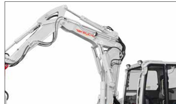
TB290-2 também disponível com braço articulado, 4 circuitos hidráulicos, 3 deles dirigidos por potenciômetros, caudal regulável.
