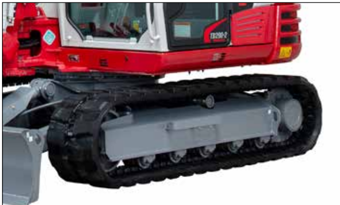
Roletos com guia interior e exterior para um funcionamento seguro das correntes de borracha Double-Short-Pitch que evitam vibrações durante a marcha.
